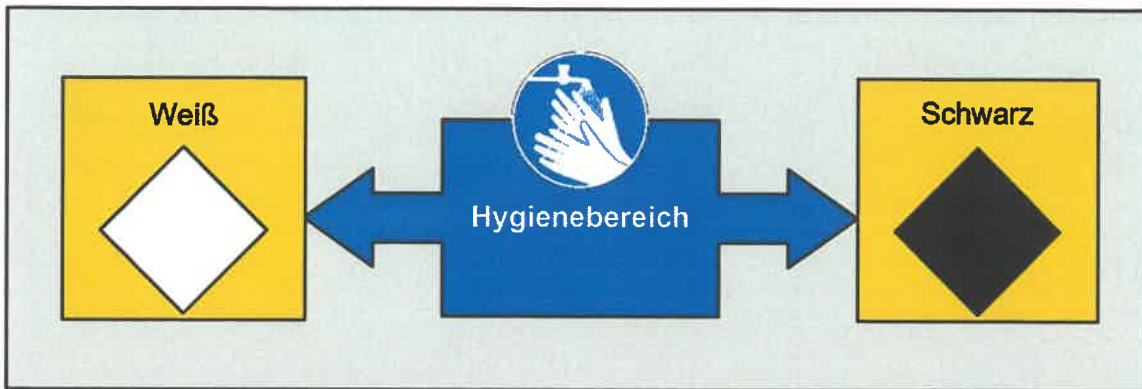
Bild 5: Grundkonzept einer SW-Anlage
